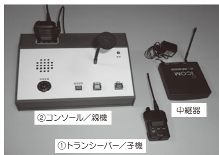
緊急放送システム (トランシーバーで校内放送できる)
