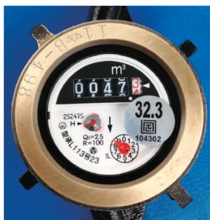
水道の使用水量がいつもより多いと感じたら、まず、水道メーターを確認してください。水道の蛇口を全部閉めた状態でパイロット(銀色の円形のもの)が回っていれば、漏水の疑いがあります。
