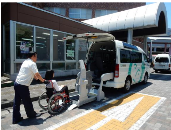
▲移送サービス リフトカー▲
